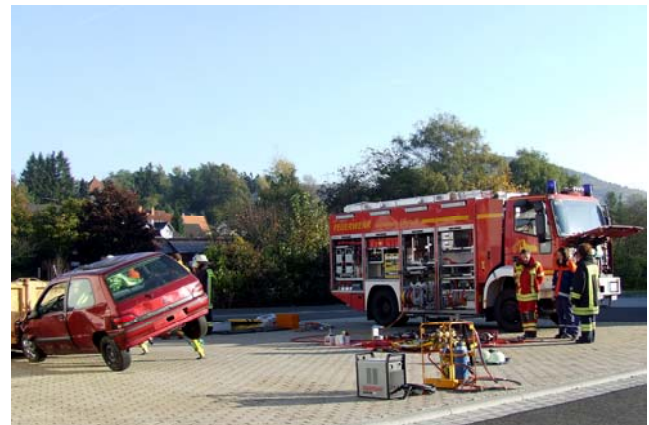
Vorbereiteter PKW abgestützt mit „Stab-Fast“
